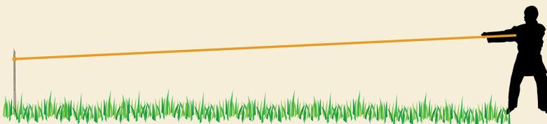
Preparare il terreno dove si poserà la recinzione in pannelli. Posare il picchetto e stendere il filo guida per poi installare i pali perfettamente allineati.
