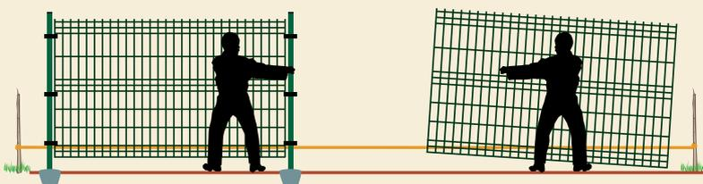
Fissare il pannello al secondo palo utilizzando i collari in acciaio. Non serrare i bulloni fino in fondo per dare la possibilità al pannello successivo di agganciarsi al collare già fissato.
