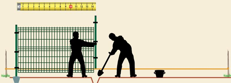
Per realizzare nel terreno il secondo foro, simulare il montaggio del secondo palo. Procedere quindi con lo scavo, posizionare il palo, cementare e ricontrollare che le distanze tra i pali in basso ed in alto siano uguali.
