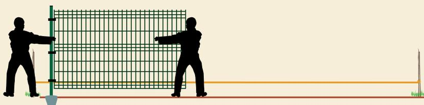
Sul primo palo inserire i collari semplici dall'alto del palo. Avvicinare il pannello ed inserire la vite 8x25 con il rispettivo dado. Non lasciare il pannello a bandiera per non compromettere la posa del palo.
