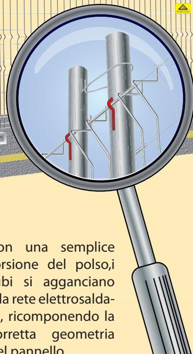
Con una semplice torsione del polso, i tubi si agganciano alla rete elettrosaldata, ricomponendo la corretta geometria del pannello
