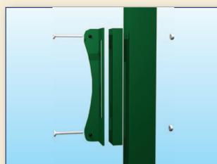
**3. Montare la controserratura sul palo in base alla direzione di apertura**
